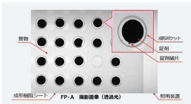
Fig. 6 透過光方式での撮影画像(FP-A)
